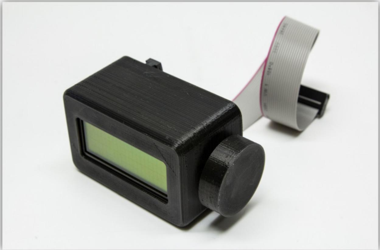
Glissez le module vers le bas dans la fente du profilé en aluminium de droite. Desserrez le support de bobine et retirez quelques attache-câbles. Il est possible que vous deviez poncer légèrement le clip de fixation à l'arrière du boîtier pour glisser facilement vers le bas.
