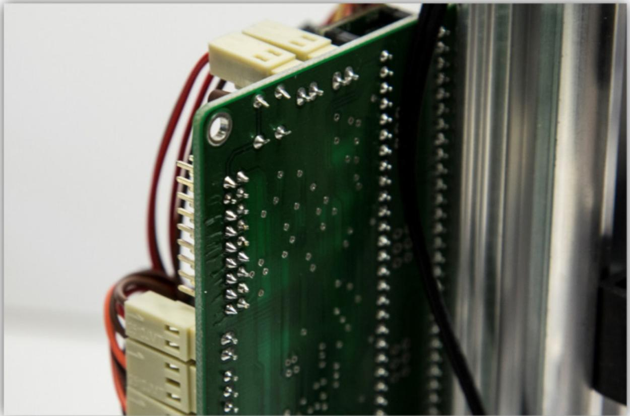
Imprimez les fichiers pour le VM8201 sur la K8200. Téléchargez-les à partir de la section de téléchargement du site web [K8200.eu](http://K8200.eu). Desserrez les 4 écrous à l'arrière du VM8201 et utilisez-les pour fixer le dos du boîtier au module.
